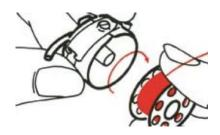
Der Unterfaden wird auf die Spule gespult und in die Spulenkapsel gelegt. Er kommt unter den Fuss ins dafür vorgesehene Gehäuse, den Greifer.
