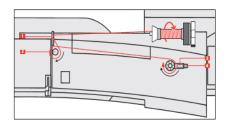
Die Fadenspule wird oben fixiert. Diesem Faden sagt man Oberfaden.
